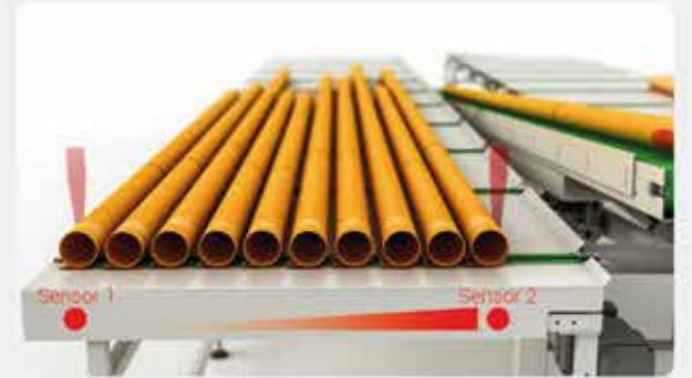
Capacity utilisation monitor
